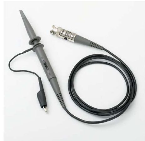
Σχήμα 6. Δομή του ακροδέκτη με διακόπτη 1:1 και 10:1. Διακρίνονται ο προσαρμογέας BNC για τη σύνδεση με την είσοδο του παλμογράφου (1), το ομοαξονικό καλώδιο (2), η κεφαλή του ακροδέκτη (3), ο διακόπτης επιλογής (4), το άκρο σύνδεσης για τη μέτρηση του σήματος (5), ο αγωγός της γείωσης (6) και το άγκιστρο (7), το οποίο προσαρμόζεται στο άκρο σύνδεσης της κεφαλής
