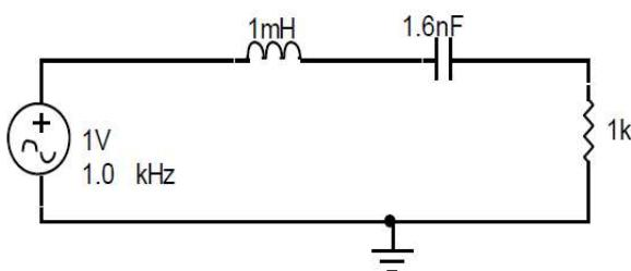
Για το διπλανό σχήμα (Α) να βρεθεί η συνάρτηση μεταφοράς και (Β) το κέρδος του κυκλώματος αν η έξοδος είναι στα άκρα της αντίστασης  $R=1\text{K}\Omega$ . Στη συνέχεια (Γ) να βρείτε τη συχνότητα (ή συχνότητες αποκοπής). Επίσης, (Δ) να αποδειχθεί ότι το κέρδος για σήμα 1KHz είναι -40dB και (Ε) να βρεθεί το κέρδος για τις συχνότητες 10KHz και 500Hz καθώς και (ΣΤ) το σήμα εξόδου αν το σήμα εισόδου είναι  $V=10\sin(2000\pi t)$ . Τέλος, (Ζ) να βρεθεί ο συντελεστής ποιότητας (αν υφίσταται ο όρος).
