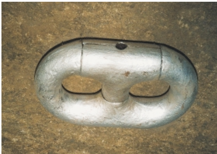
Εικόνα 12.13: Λύσιμο αγκύλιο (κλειδί) σύνδεσης αμμάτων τύπου "KENTER". Παράπλευρα φαίνονται τα μέρη από τα οποία αποτελείται.
