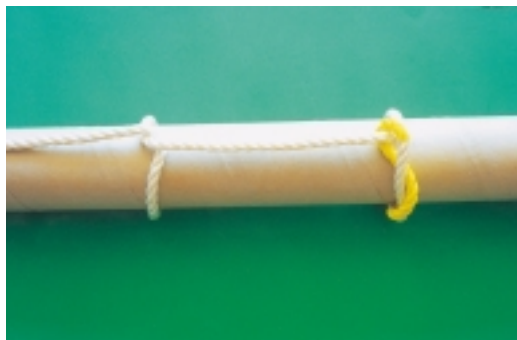
Εικόνα 7.26: Ξυλόδεσμος με ημίδεσμο
