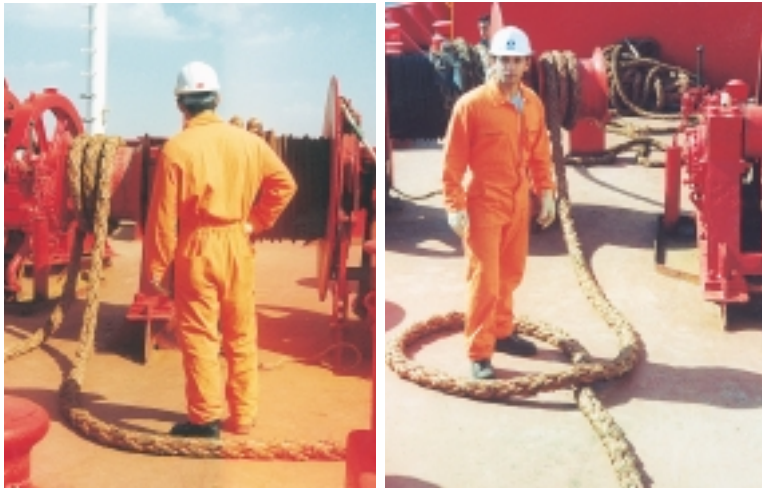
Εικόνα 4.12 (δ), (ε): Ο ναυτικός δεν πρέπει να αφαιρείται όταν συμμετέχει σε εργασίες πρόδρασης του πλοίου. Πάντοτε πρέπει να βρίσκεται σε θέση «νέτα» από τους κάβους που βιράρονται ή πρόκειται να βιραριστούν.
