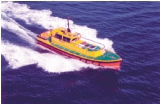
Εικόνα 3.38: Μικρό βοηθητικό σκάφος το οποίο χρησιμεύει για τη μεταφορά των πλοηγών (πλοτίνια)
