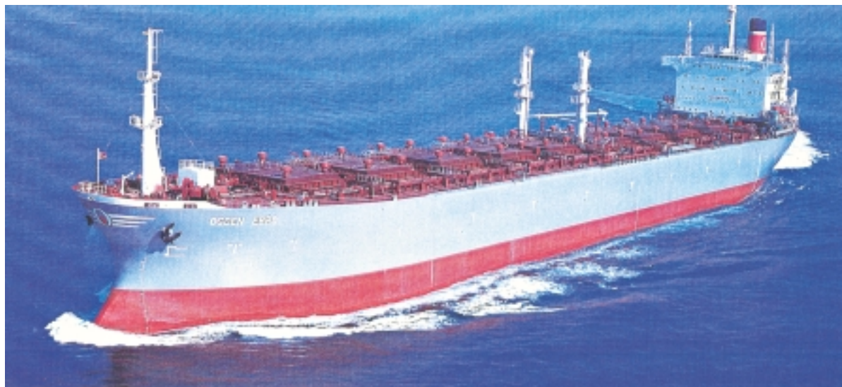
Εικόνα 3.8: Πλοίο το οποίο μεταφέρει ορυκτά χύμα, οποιοδήποτε άλλο χύμα φορτίο και εναλλακτικά, πετρέλαιο. (Ore/Bulk/Oil carrier ή O.B.O. carrier)
