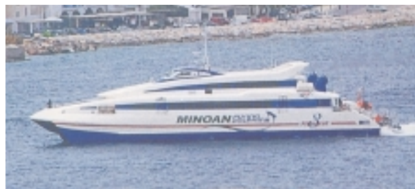
Εικόνα 3.27 (α): Μικρό ταχύπλοο επιβατηγό πλοίο τύπου Καταμαράν (Catamaran ή Flying Cat όπως συνηθέστερα λέγεται)
