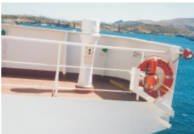
Εικόνα 9.4: Κυκλικό σωσίβιο τοποθετημένο στην δεξιά πλευρά της γέφυρας
