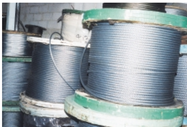
Εικόνα 6.7: Κορκώματα διάφορων καινούργιων συρματόσχοινων
