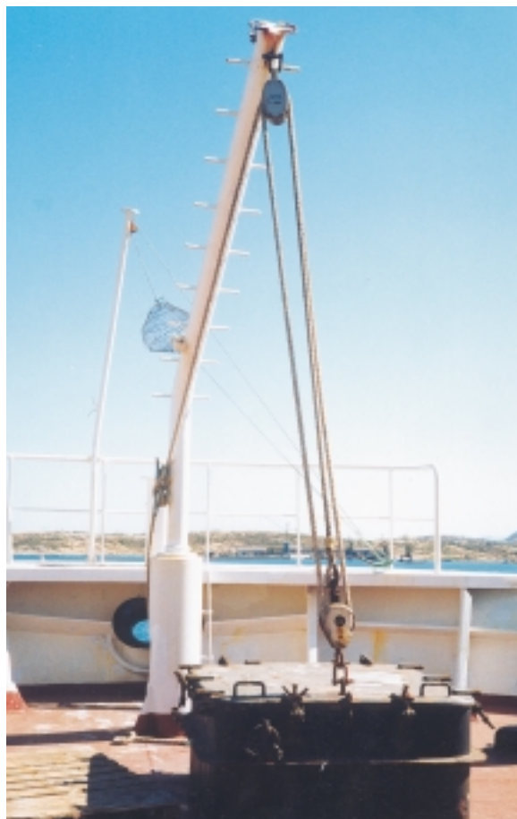
Εικόνα 11.9: Σύσπαστο (παλάγκο) στην πλώρη του πλοίου που χρησιμεύει για το σήκωμα (άνοιγμα) της πόρτας (ρούμιου) που οδηγεί στις αποθήκες του προστέγου
