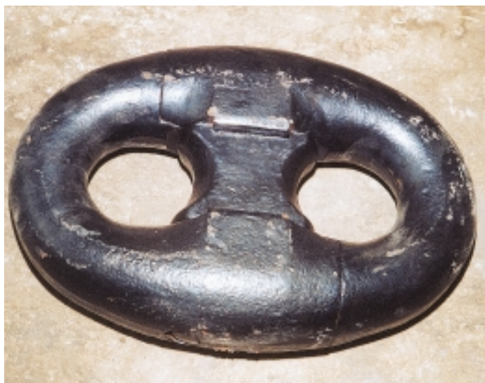
Εικόνα 12.12: Ανόμοιος τύπος κλειδιού αλυσίδας άγκυρών που χρησιμοποιείται στα σύγχρονα πλοία. Παράπλευρα φαίνονται σχηματικά τα μέρη από τα οποία αποτελείται και η σύνδεσή του με την αλυσίδα (καδένα).
