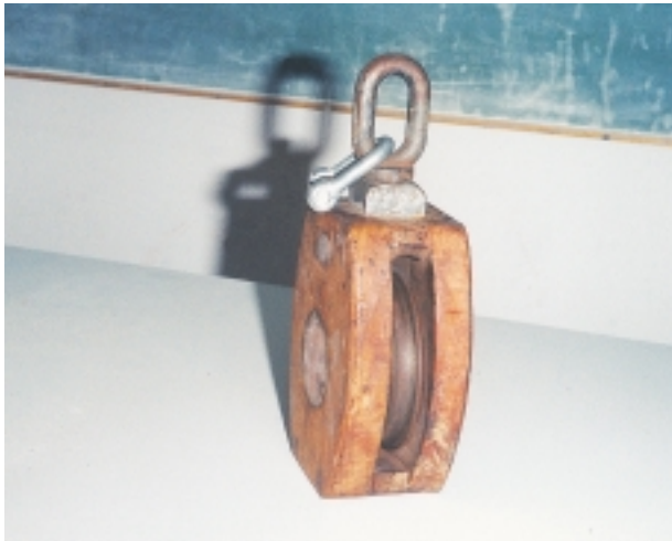
Εικόνα 11.1: Περιγραφή ξύλινου τρόχilon (μακαρά) 1. Παρειά (μάγουλο) 2. Κάρνο (ράουλο) 3. Άξονας (κάτω από την πινακίδα) 4. Δακτύλιος 5. Λαγμός 6. Έδρα
