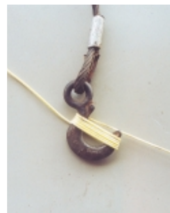
Εικόνα 7.23 (α): Ξεκίνημα «φιμώματος» γάντζου
