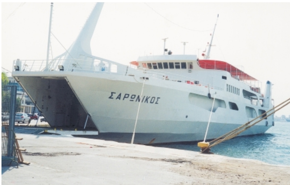
Εικόνα 3.28: Μικρό επιβατηγό - οχηματαγωγό πλοίο ανοιχτού τύπου, κοντινών αποστάσεων (πορθμείο)
