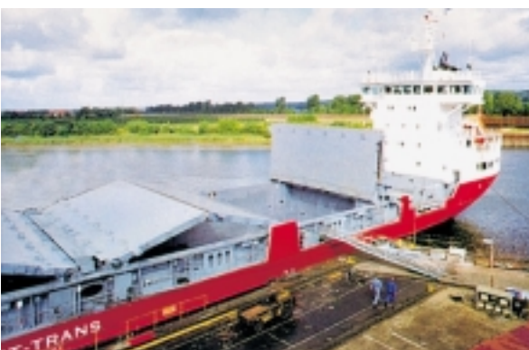
Εικόνα 13.5 (α), (β): Πλοία με πτυσσόμενα καλύμματα ανυψώμενα με υδραυλική πίεση
