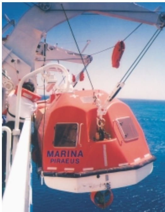
Εικόνα 8.16 (α): Καθαίρεση σωσίβιας λέμβου με επωτίδες βαρύτητας στη θέση επιβίβασης
