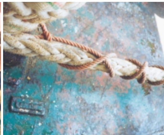
Εικόνα 7.13 (δ): Τελείωμα και κράτημα σταυρωτού μπότσου σε κάβο
