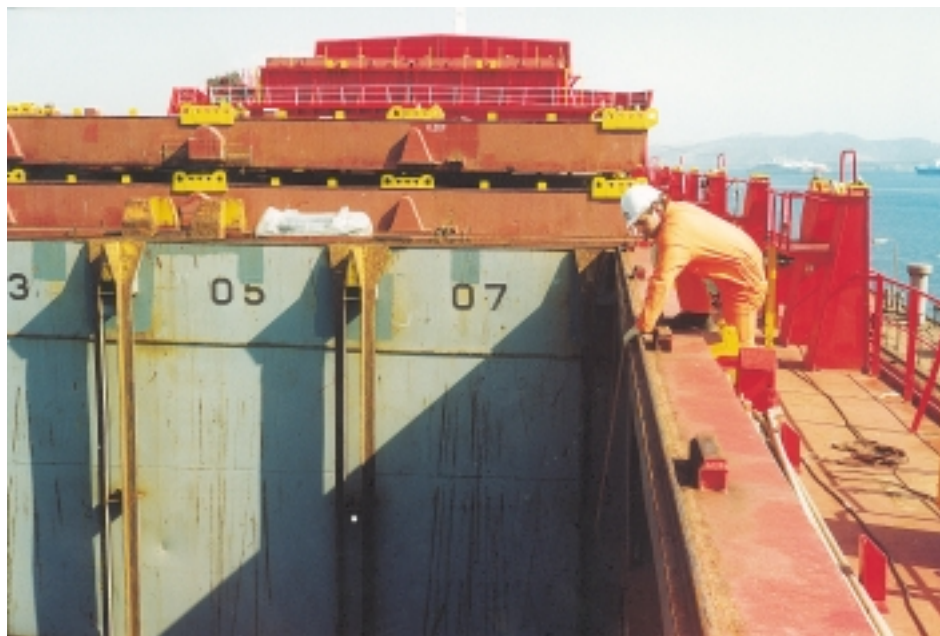
Εικόνα 4.3: Λανθασμένος και επικίνδυνος τρόπος να «επιθεωρούμε» ένα αμπάρι από το χείλος του κουβουσιού. Το σωστό είναι, το κέντρο βάρους του σώματος να παραμένει αισθητά έξω και κάτω από το χείλος του κουβουσιού και μόνο το κεφάλι να περνάει μέσα από αυτό.
