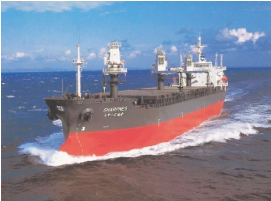
Εικόνα 3.5: Πλοίο μεταφοράς χύμα φορτίων, χρησιμοποιούμενο κυρίως στην μεταφορά σιτηρών. Επειδή διαθέτει δικά του φορτοεκφορτωτικά μέσα, χρησιμοποιείται επίσης και στη μεταφορά τυποποιημένων φορτίων.
