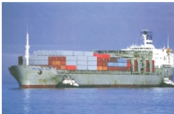
Εικόνα 3.10 (γ): Ένας άλλος τύπος πλοίων μεταφοράς εμπορευματοκιβωτίων, το οποίο διαθέτει και δικά του μέσα φορτοεκφόρτωσης.
