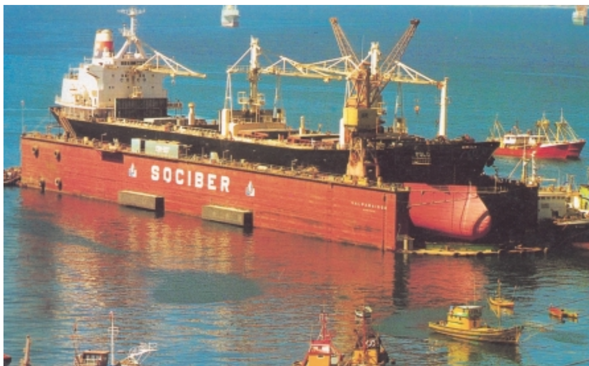
Εικόνα 3.43: Πλωτή δεξαμενή για το δεξαμενισμό πλοίων. Διακρίνεται και ένα πλοίο μέσα σε αυτή.
