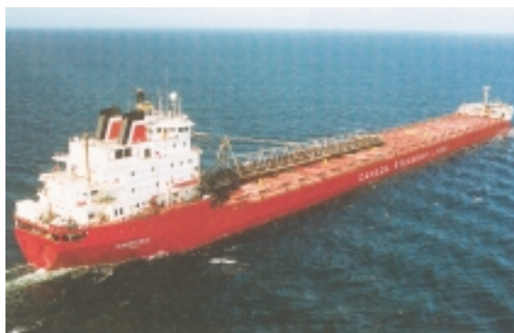
Εικόνα 3.37: Φορηγό πλοίο που μεταφέρει χύμα φορτία μέσα σε λίμνες και ποτάμια (κλειστά νερά). Στο πρυμνίο μέρος του καταστρώματος φαίνεται το εξωτερικό τμήμα του εκφορτωτικού μηχανήματος (siló) που διαθέτει αυτός ο τύπος του πλοίου.
