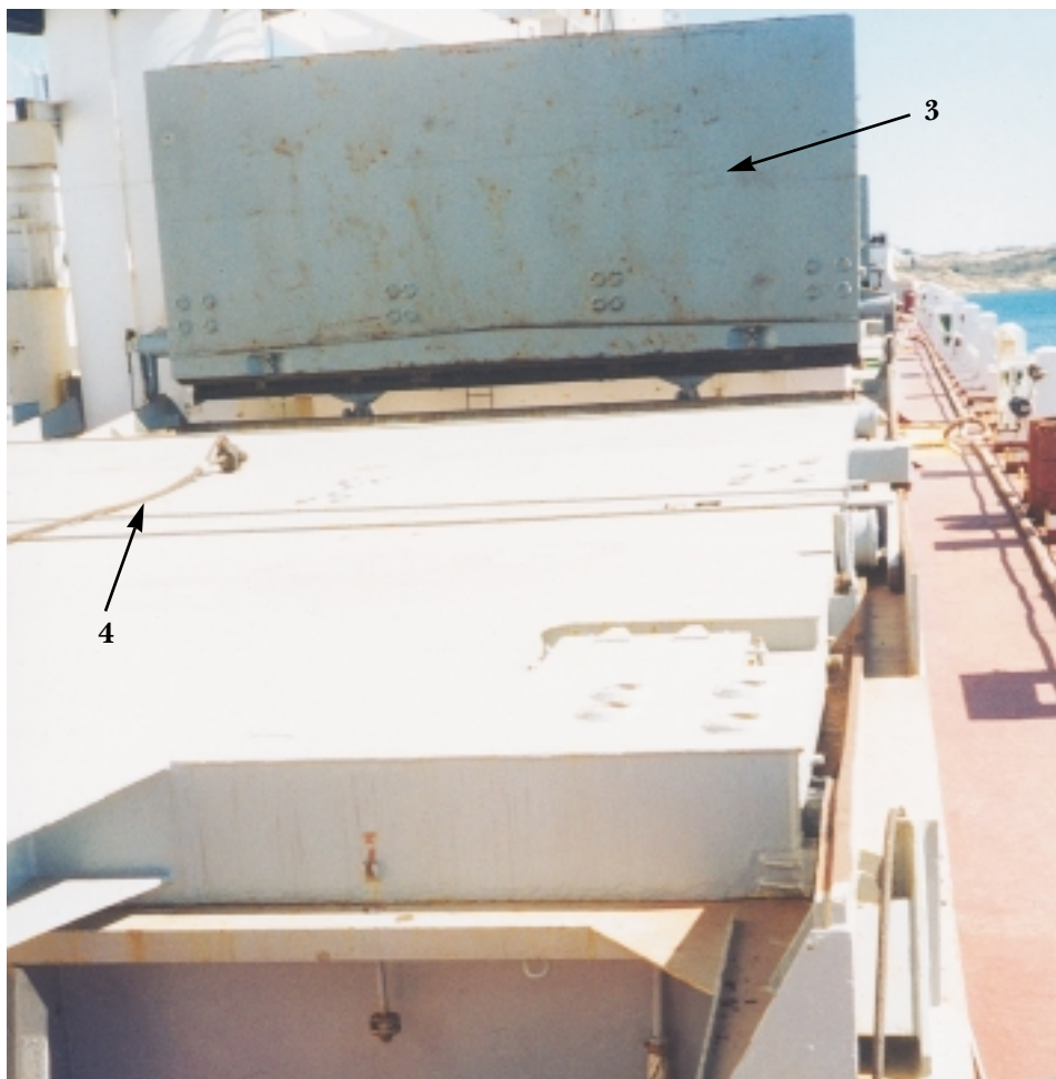
Εικόνα 13.3 (α), (β): Καλύμματα απλής έλξης 1. Σφήνες σύνδεσης τμημάτων 2. Αλυσίδα (καδένα) με τον τροχό τμήματος καλύμματος κύτους 3. Τμήμα καλύμματος υπερικωμένο πλώρα από το άνοιγμα του κύτους 4. Σύρμα έλξης για το άνοιγμα των καλυμμάτων
