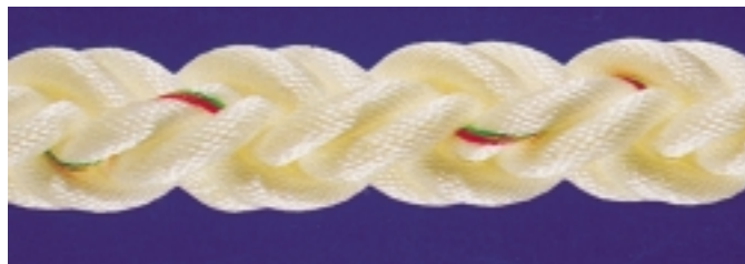
Εικόνα 6.3 (β): Σχοινί για το δέσιμο των πλοίων (κάβος) με πλέξη των ἐμβόλων του ανά ζεύγη
