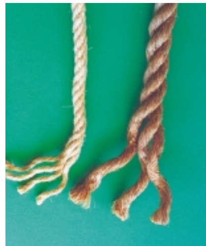
Εικόνα 6.1: Σχοινιά από φυτικές ίνες, έντριπο και εντέταρτο αντίστοιχα
