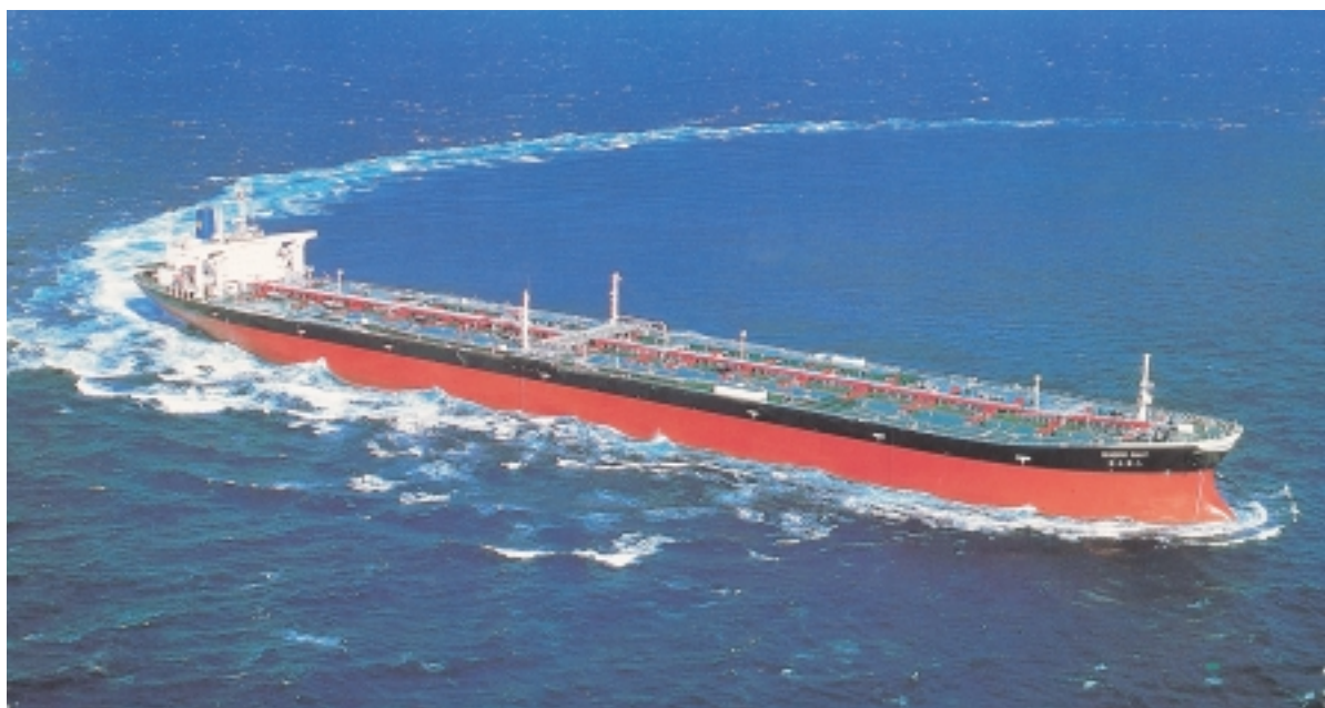
Εικόνα 3.17: Δεξαμενόπλοιο μεταφοράς ακάθαρτου (αργού πετρελαίου) τύπου ULCC.
