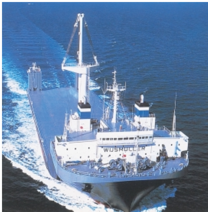
Εικόνα 3.14: Πλοίο το οποίο μεταφέρει φορτηγίδες ή φορτηγίδες και εμπορευματοκιβώτια. Είναι μια παραλλαγή του φορτηγιδοφόρου SEABEE αλλά, σε αντίθεση με αυτό, δεν βυθίζεται τελείως όταν πρόκειται να φορτωεκφορτώσει, απλά έχει τη δυνατότητα να μεταβάλλει αισθητά τη διαγωγή του αυξομειώνοντας ανάλογα το πλωριό ή το πρυμνιό βύθισμά του (γι' αυτό και λέγεται «ημβυθιζόμενου τύπου»).
