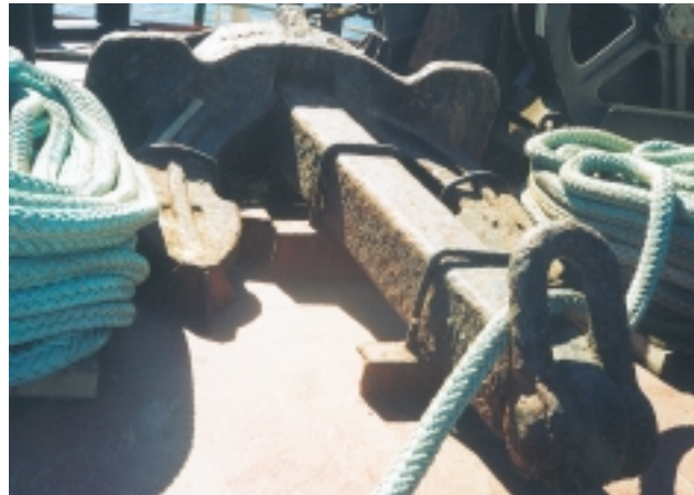
Εικόνα 12.9: Εφεδρική άγκυρα ασφαλισμένη στη θέση της πάνω στο πρόστεγο του πλοίου
