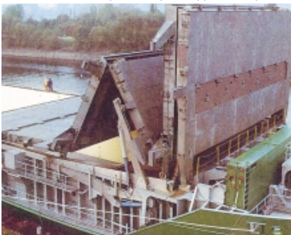
Εικόνα 13.4 (α), (β): Πλοία με καλύμματα κυλιόμενα
