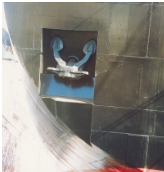
Εικόνα 12.10: Πρυμνιά άγκυρα στη θέση ασφάλισής της
