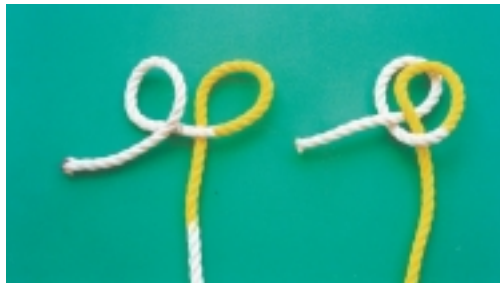
Εικόνα 7.24 (α): Κατασκευή της ψαλιδιάς
