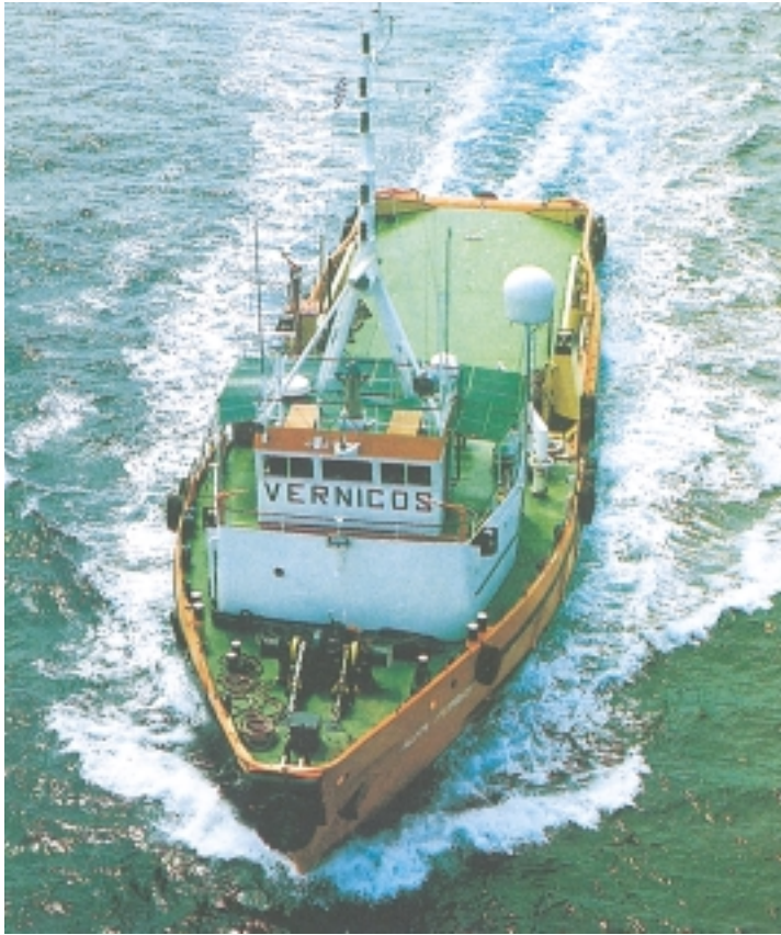
Εικόνα 3.34: Πλοίο το οποίο χρησιμοποιείται κυρίως ως ναυαγοσωστικό, αλλά και ως ρυμουλκό ανοιχτής θάλασσας για ρυμουλκώσεις (πλοίων ή πλωτών ναυπηγημάτων) σε μεγάλες αποστάσεις.
