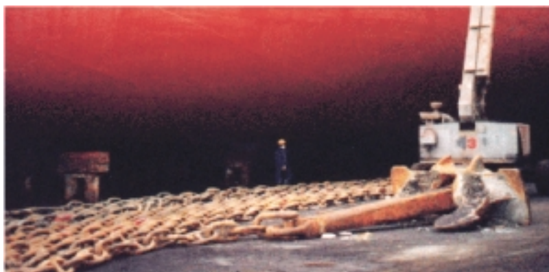
Εικόνα 12.16: Επιθεώρηση και δοκιμή της καδένας
