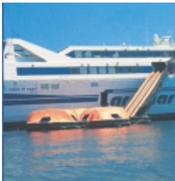
Εικόνα 8.14: Διάδρομος διαφυγής (ολισθητήρας εγκατάλειψης πλοίου)
