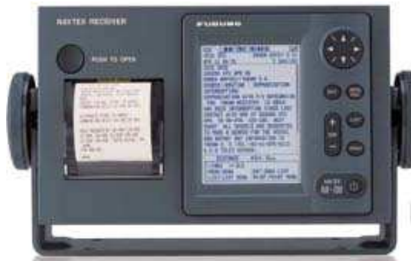
Σύστημα Navtex - Λήψη μηνυμάτων από την συσκευή
