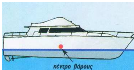
Σχήμα (1): Θέση του κέντρου βάρους
