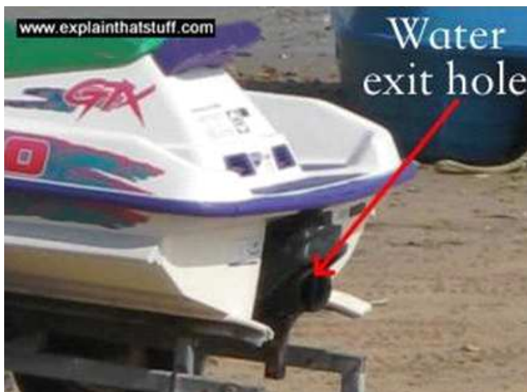
Το θαλασσινό νερό αναρροφάται μέσα από μια σχάρα πρόσληψης στο κάτω μέρος και εξέρχεται από ένα κατευθυνόμενο ακροφύσιο στο πίσω μέρος του σκάφους
