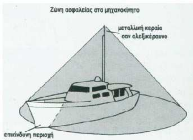
Αντικεραυνική προστασία σκάφους και αλεξικέρανο σκάφους
