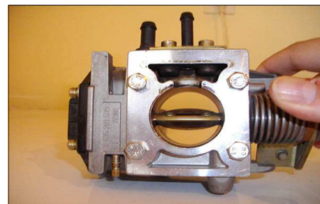
Το χειριστήριο γκαζιού έχει μετακινηθεί και η πεταλούδα γκαζιού είναι ανοιχτή
