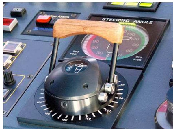
Χειριστήρια του αξιμουθιακού συστήματος από τη γέφυρα του σκάφους
