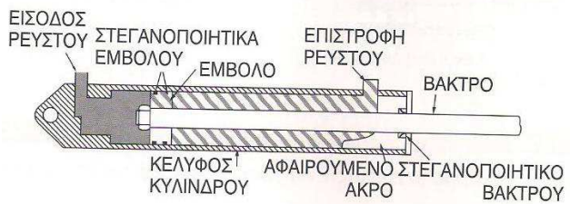
Υδραυλικός κύλινδρος διπλής ενέργειας
