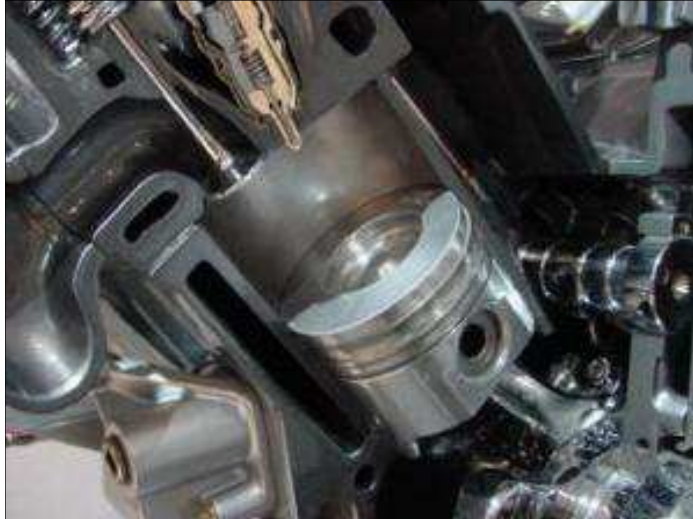
Μεσόστροφη πετρελαιομηχανή σε τομή Διακρίνεται η τοποθέτηση του εγχυτήρα στο πώμα του κυλίνδρου, καθώς και η κοιλότητα του εμβόλου στο άνω μέρος του
