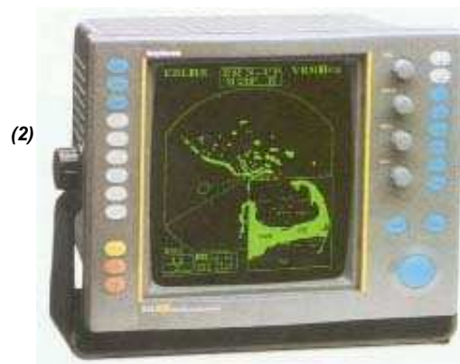
(1) Η κεραία του Ραντάρ στην οποία βρίσκονται, ο πομπός, διακόπτης εναλλαγής πομπού-δέκτη (T/R switch) και (2) ο δέκτης/μονάδα ένδειξης, οθόνη τύπου λυχνίας TV ή υγρού κρυστάλλου (LCD)
