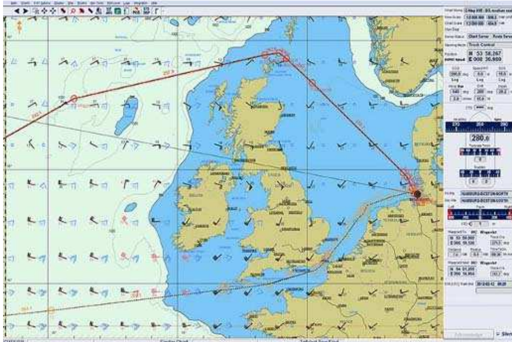
Σχεδιασμένη πορεία πάνω σε ηλεκτρονικό χάρτη στο σύστημα ECDIS Ολοκληρωμένα Συστήματα Πλοήγησης
