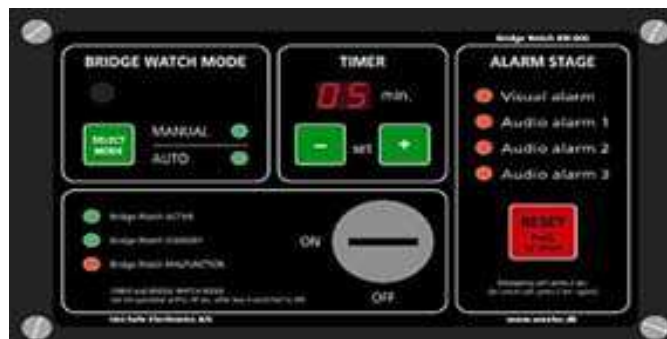
Κεντρική μονάδα BNWAS
