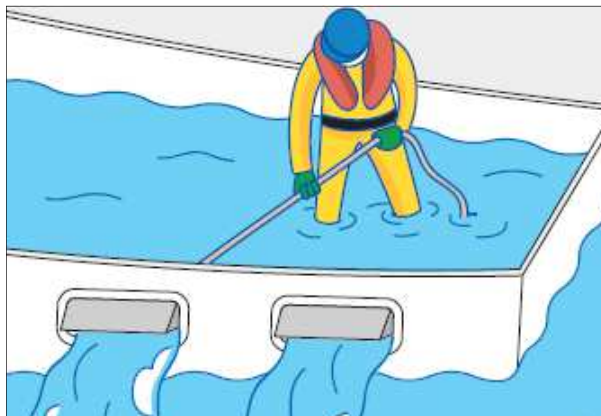
Νερό που ρεύει ανεμπόδιστα στο κατάστρωμα του σκάφους δημιουργεί το φαινόμενο της ελεύθερης επιφάνειας
