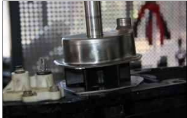
Έλεγχος IMPELLER (εξάρτημα αντλίας κυκλοφορίας ψύξης)
