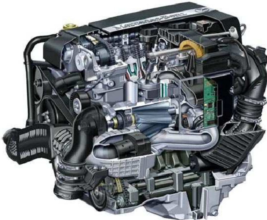
Κινητήρας με COMPRESSOR-SUPERCHARGER
