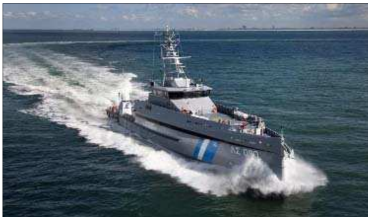
Υπερσύγχρονο ταχύπλοο σκάφος - Περιπολικό Ανοικτής Θαλάσσης / ΠΑΘ 090 «Γαύδος» του Λιμενικού Σώματος / Ελληνικής Ακτοφυλακής με κάθετο σχήμα πλώρης
