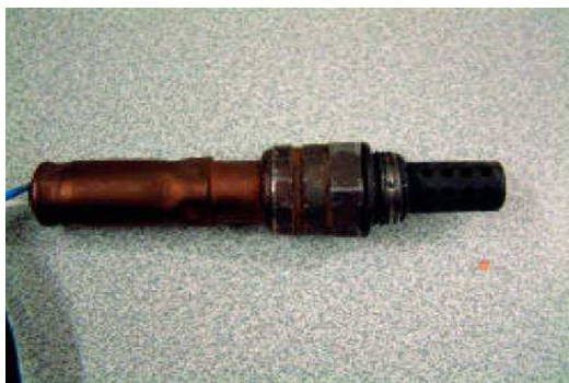
Αισθητήρας λάμδα (λ) και η καμπύλη τάσης εξόδου του
