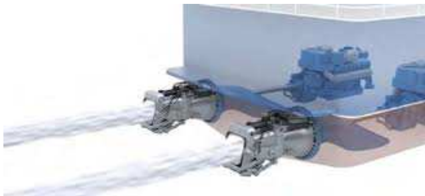
Σύστημα προωθητήρων αντίδρασης Rolls-Royce KAMEWA σε σκάφος
