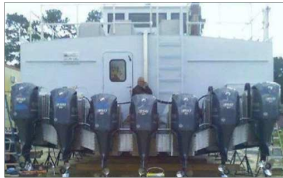
Καθρέπτης Πρύμνης σκάφους που φέρει συγκρότημα επτά (7) εξωλέμβιων κινητήρων
