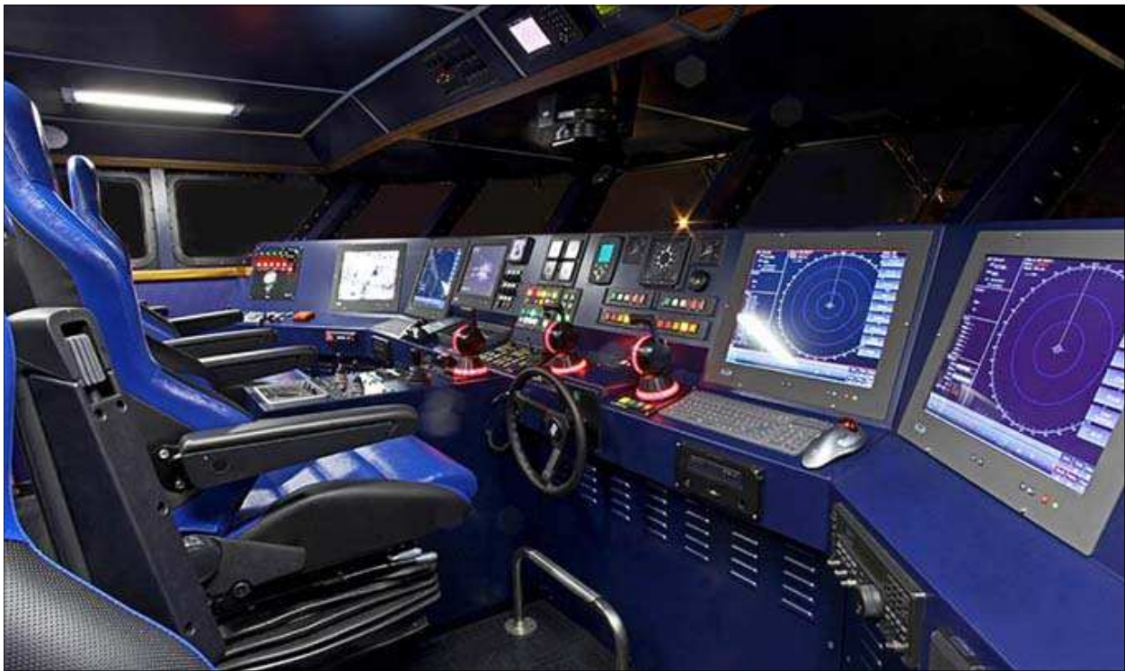
Κόκπιτ (Cockpit) / Χώρος πηδαλιουχίας ταχύπλοου σκάφους Ακτοφυλακής με τα απαραίτητα όργανα γέφυρας και μηχανών
