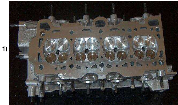
1) Κυλινδροκεφαλή με 4 βαλβίδες, δύο Εισαγωγής και δύο Εξαγωγής ανά κύλινδρο και 2) ο κορμός πετρελαιοκινητήρα
