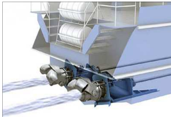
Water jet - Προωθητήρες αντίδρασης
