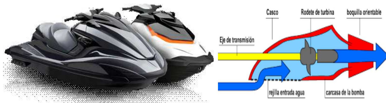
Το «JET SKI» και σε τομή το σύστημα του προωθητήρα αντίδρασης
