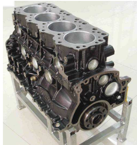
1) Κυλινδροκεφαλή με 4 βαλβίδες, δύο Εισαγωγής και δύο Εξαγωγής ανά κύλινδρο και 2) ο κορμός πετρελαιοκινητήρα
