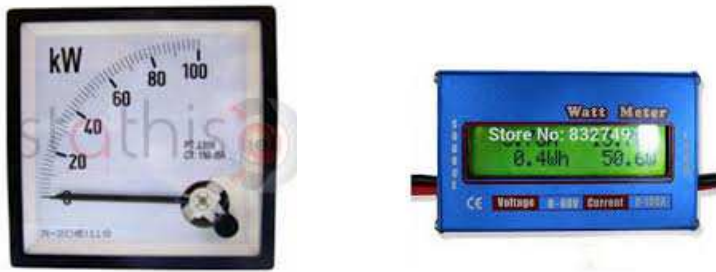
Αναλογικό και ψηφιακό κιλοβαττόμετρο/βατόμετρο
