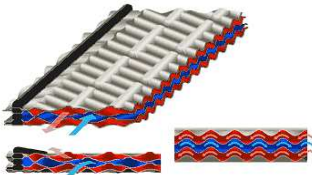
Αυλακώσεις μεταξύ πλακών όπου με κόκκινο χρώμα είναι το ψυχώμενο υγρό και με μπλε είναι το μέσο ψύξης ενός πλακοειδή εναλλάκτη και στις άκρες με μαύρο οι φλάντζες στεγανοποίησης
