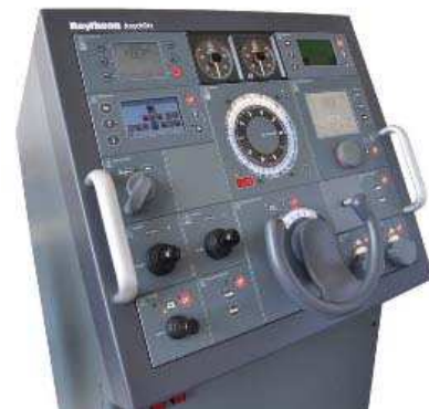
Σύγχρονο σύστημα (πηδαλιό) πηδαλιουχίσιας
