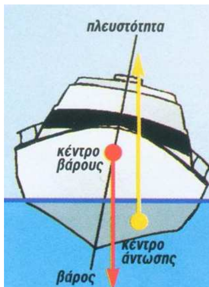
Σχήμα (3): Πρωραία σχηματική απεικόνιση του κέντρου βάρους και αυτό της άντωσης, τα οποία μετατοπίζονται προς την πλευρά της κλίσης του σκάφους
