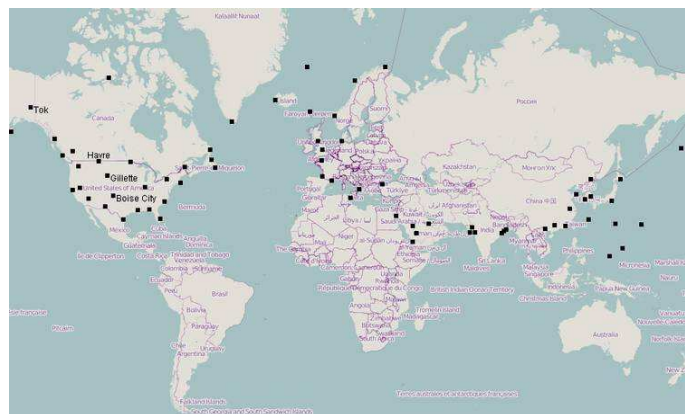
Οι σταθμοί εκπομπής του συστήματος LORAN-C
