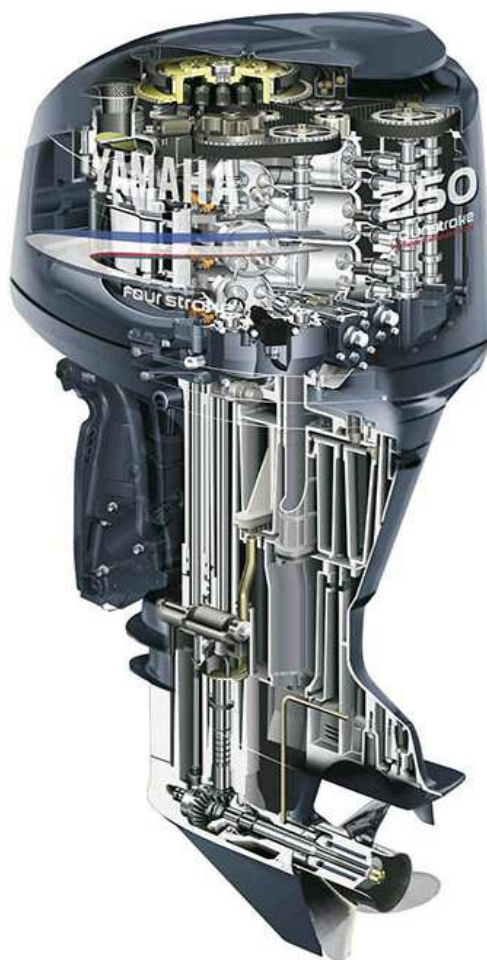
Τομή σύγχρονης εξωλέμβιας μηχανής
