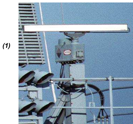
(1) Η κεραία του Ραντάρ στην οποία βρίσκονται, ο πομπός, διακόπτης εναλλαγής πομπού-δέκτη (T/R switch) και (2) ο δέκτης/μονάδα ένδειξης, οθόνη τύπου λυχνίας TV ή υγρού κρυστάλλου (LCD)
