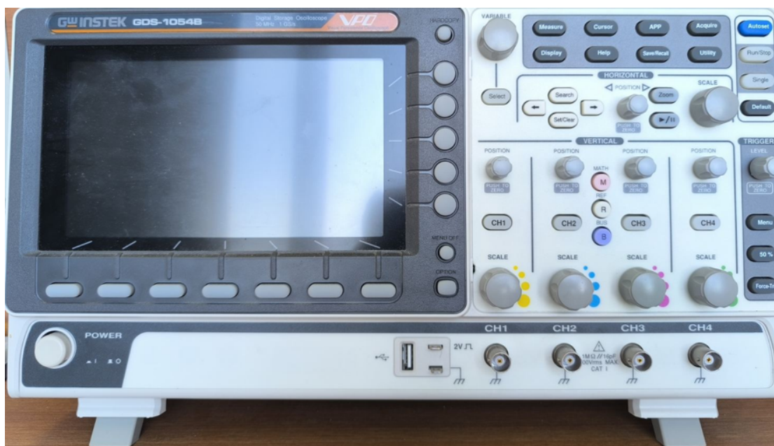
Σχήμα 3: Ψηφιακός παλμογράφος GW Instek GDS-1054B του εργαστηρίου.
