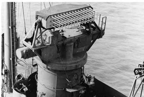
Εικόνα 14: Το radar πυροβολικού Mk 8 εν έτει 1943 επί του κατευθυντήρα Mk 38 στην πρωραία υπερκατασκευή του USS Mobile (CL 63) στο Mare Island Navy Yard, CA 67
