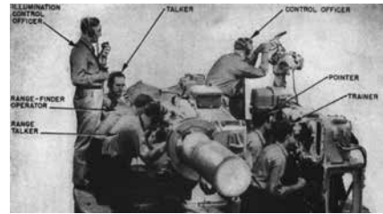
Εικόνα 9: Επάνω: η θέση του αποστασιόμετρου στο θωρηκτό Fuso του ιαπωνικού αυτοκρατορικού ναυτικού. Κάτω δεξιά: ο κατευθυντήρας Mk 19 επί του USS Pennsylvania (BB-38) περί το 1942 με εμφανή τα σκοπευτικά του rangefinder στο δεξί άκρο της φωτιά. Κάτω αριστερά: στελέχωση του rangefinder στο booth του κατευθυντήρα 53
