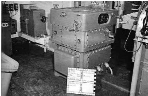
Εικόνα 10: Ο σταθμιστήρας Mk32 (αριστερά) και το σύστημα γυροσκοπίου Mk6 (δεξιά) 56
