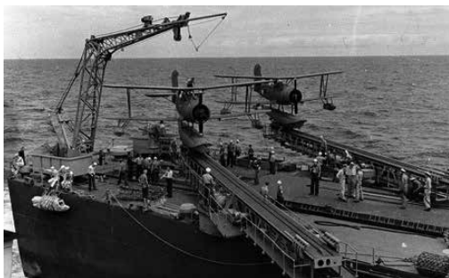
Εικόνα 8: Υδροπλάνα OS2U Kingfisher ασφαλισμένα στους πρυμναίους καταπέλτες άγνωστου θωρηκτού. Προσέξτε τον γερανό περισυλλογής των
