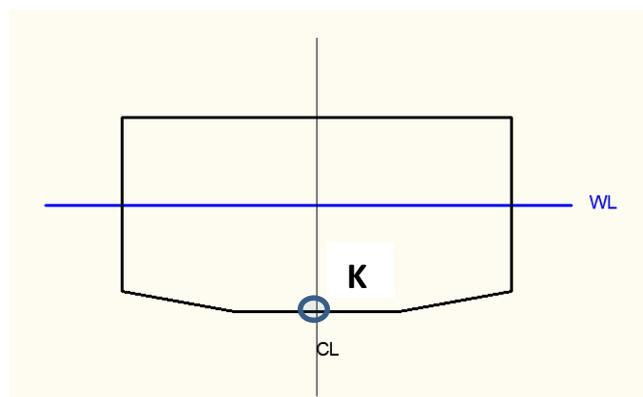
3. Σ' ένα πλοίο με εκτόπισμα  $\Delta=8000 \text{ t}$  θα βγάλουμε ένα φορτίο βάρους  $w=60 \text{ t}$  με  $KG=1,5\text{m}$  από ένα αμπάρι συμμετρικό ως προς τον κατακόρυφο άξονα συμμετρίας. Για να το βγάλουμε θα χρησιμοποιήσουμε το γερανό του πλοίου του οποίου το σημείο ανάρτησης απέχει  $30 \text{ m}$  από την τρόπιδα  $K$ . Αν γνωρίζετε ότι το πλοίο είχε αρχικά  $KG=7,5 \text{ m}$ , υπολογίστε:
