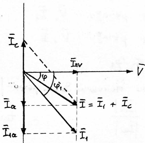
$\bar{I}_L$ : ρείκα που διαρρέει την  $\bar{Z}$ , με  $\bar{I}_L = \bar{I}_{av} + \bar{I}_{1a}$
